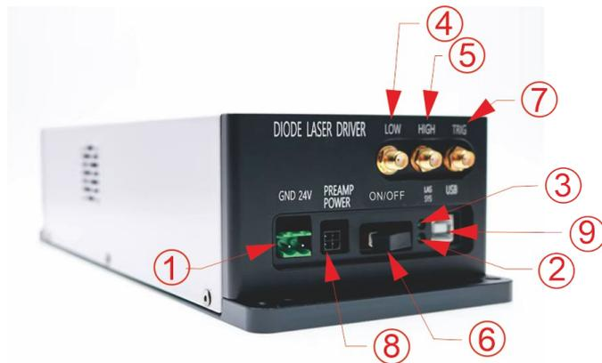
1电源输入;2电源指示;3工作指示;4低频输入;5高频输入;6手动按钮;7触发按钮;8放大器电源 ;9 USB接口
