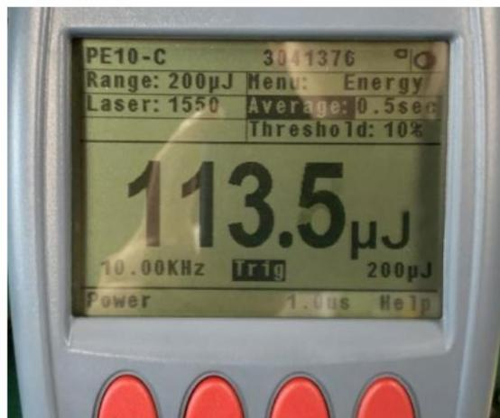
脉宽测试和脉冲能量测试@10kHz, 3ns
