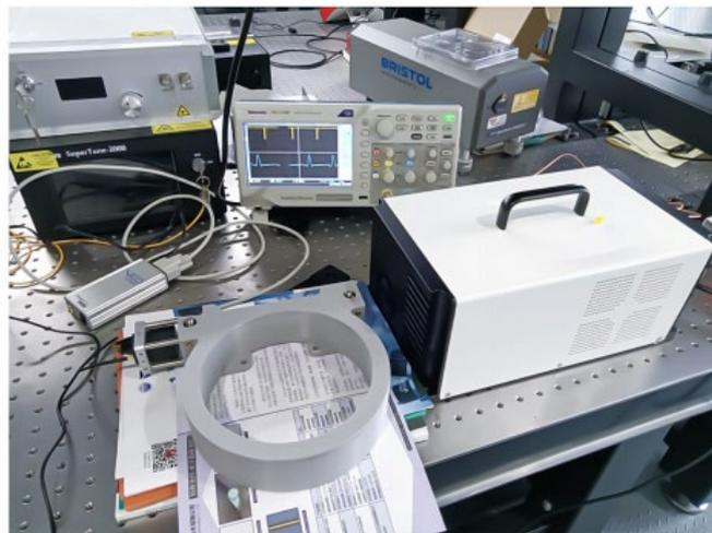
NF<sub>3</sub>气体吸收测量实验系统图
