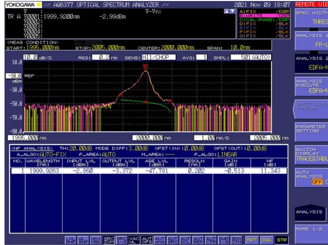
上图中Trace A (黄色) 为种子光光谱图, Trace B (紫色) 为放大后光谱图 (经过2um衰减器), 下同。在2000nm处测得的放大噪声为11.343dB。
