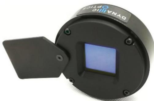
电介质涂层变形镜-带有嵌入式电子器件
