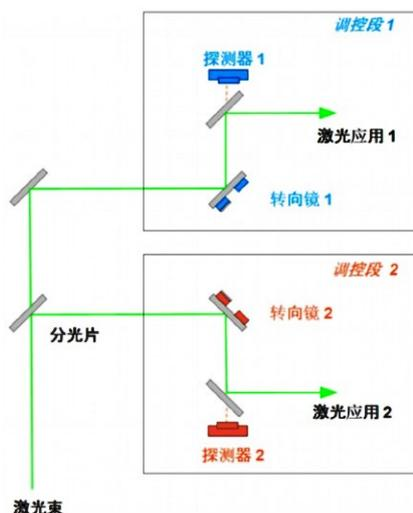
图 8e: 4-轴调控系统被用作 2 个 2-轴调控系统。
