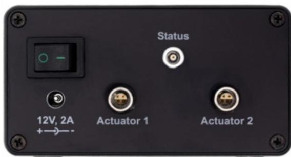
外壳左侧的电源输入和输出插座
