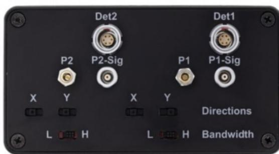
外壳右侧的输入插座和滑动开关
