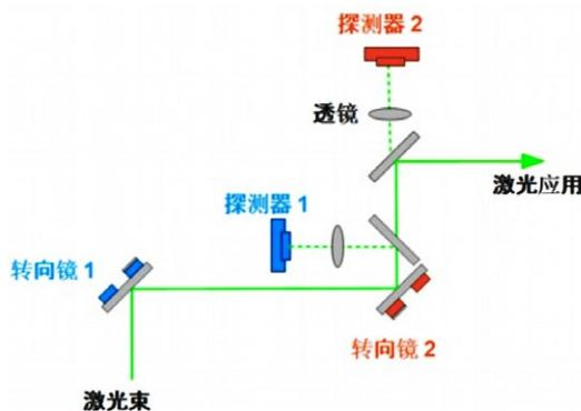
图 8b: 设置与 8a 相似, 探测器 1 前另加一个分光片和一透镜, 探测器 2 前另设一透镜。
