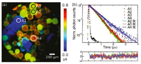
图像(a): 通过TimepixCam获得, TimepixCam是TPX3CAM的前一个模型。 图像(b): 对于(a)中所示的A1-A4区域,强度是时间的函数(磷光衰减), 磷光衰减和拟合的残差具有单指数拟合。
