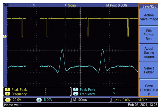
7.4umDFB-QCL激光器通过气室对水吸收测量幅值
