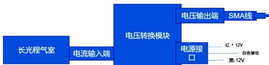
电压转换模块需同时加载上±12V直流电压后方能工作。
